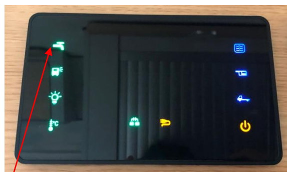
Bouton de mise sous tension de la pompe
