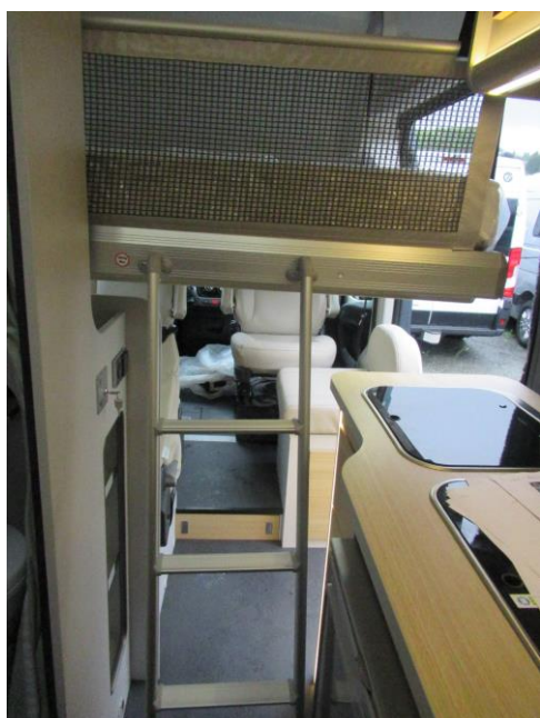
Filet de sécurité et échelle en position
