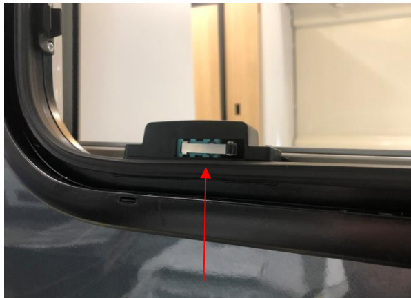
Contacteur de baie
