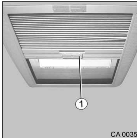
Fig. 54 Stores sur le lanterneau
