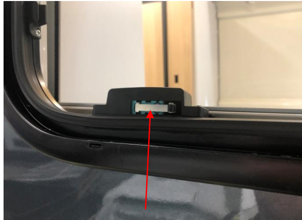
Contacteur de baie
