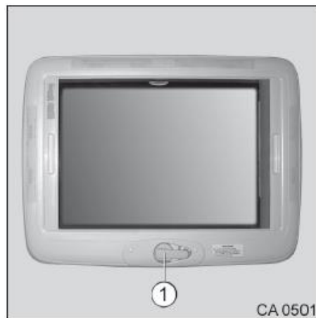
Afb. 65 Dakluik met handslinger
