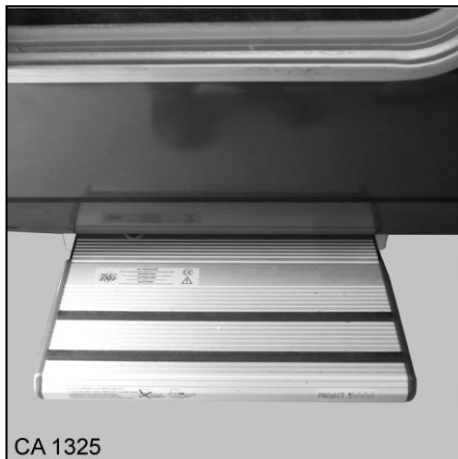
Afb. 11 Instap cabinedeur met één trede
