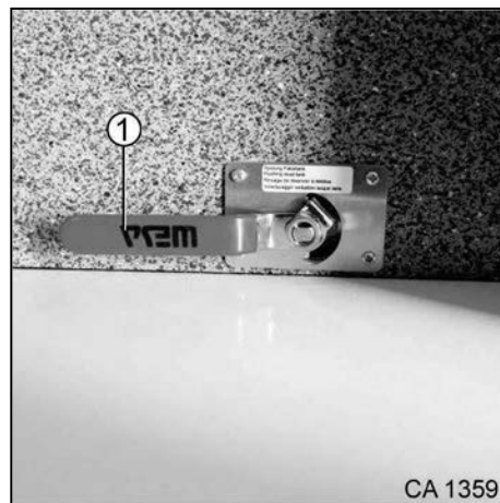
Afb. 176 Aftapkraan (gesloten) voor afvalwater van afvalwatertank
