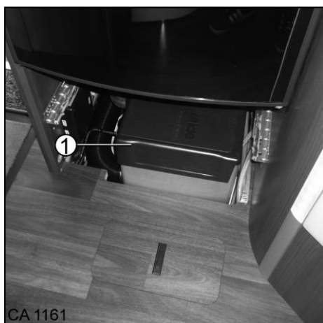
Fig. 131 Emplacement du chauffage
