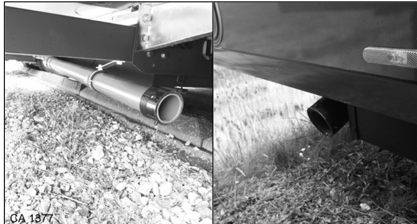
Fig. 172 Manchon de vidange sur le modèle e-line/manchon de vidange sur le modèle s-plus
