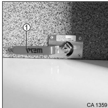
Fig. 176 Robinet de vidange (fermé) des eaux grises du réservoir des eaux usées
