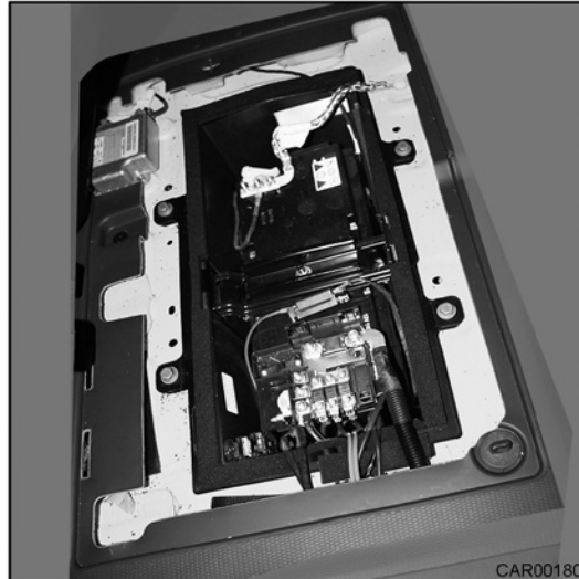
Fig. 221 Remplacer la batterie du véhicule
