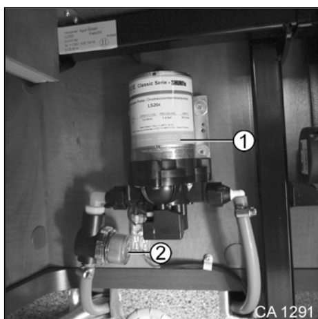
Fig. 182 Pompe à eau
