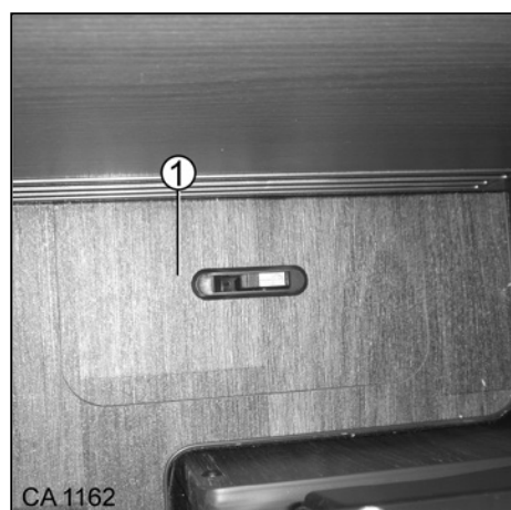
Fig. 141 Emplacement du robinet d'arrêt de l'échangeur thermique Iveco
