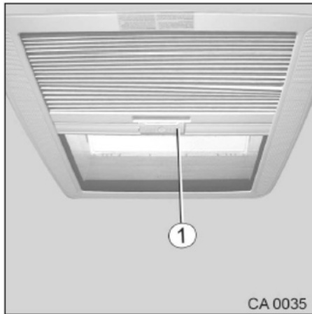
Fig. 77 Stores du lanterneau
