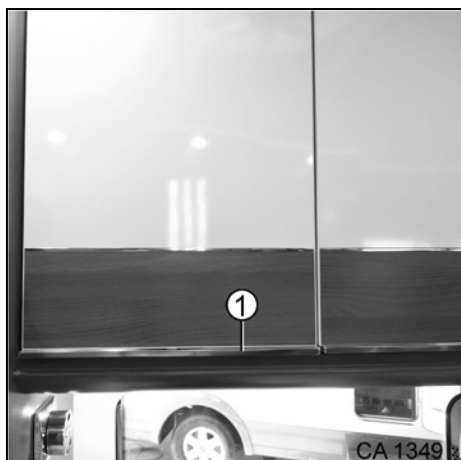
Fig. 116 Fermeture à poignée des placards de pavillon en cuisine
