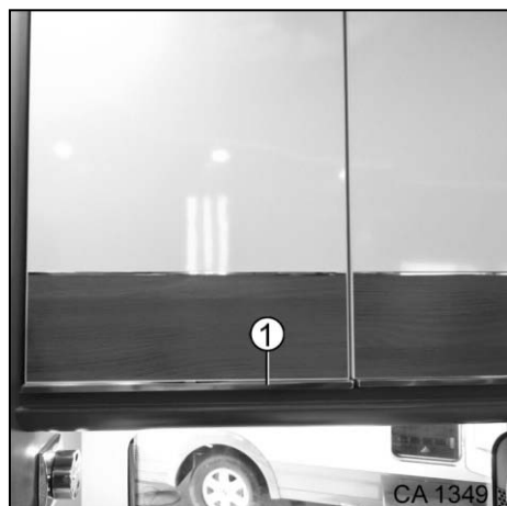
Fig. 108 Fermeture à poignée des placards de pavillon en cuisine
