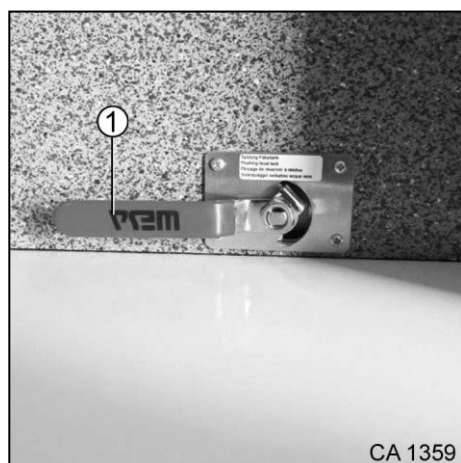
Fig. 167 Robinet de vidange (fermé) des eaux grises du réservoir des eaux usées
