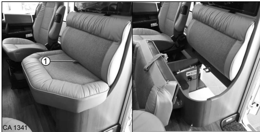
Fig. 85 Mécanisme de rabat de la banquette latérale courte
