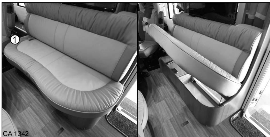
Fig. 86 Mécanisme de rabat de la banquette latérale longue
