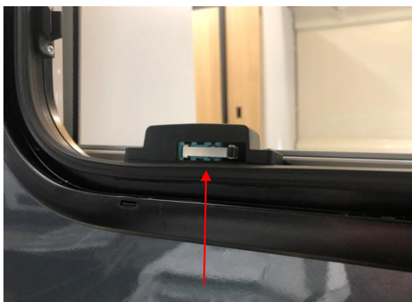
Contacteur de baie
