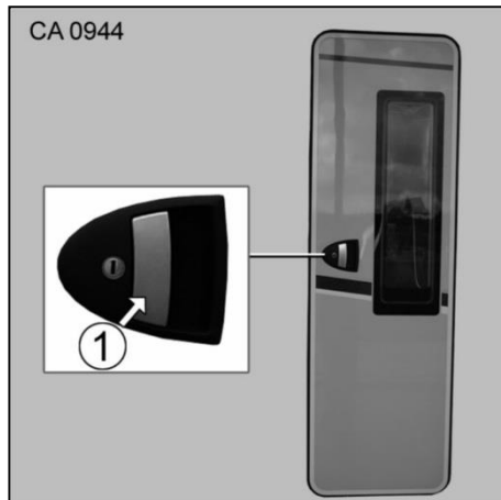
Fig. 38 Extérieur de la portière d'accès
