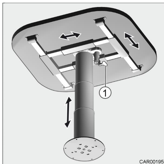
Fig. 66 Table abaissable (sans levier) et coulissante (avec levier)
