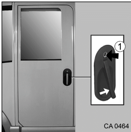
Fig. 36 Extérieur de la portière de cabine
