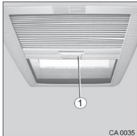
Fig. 56 Stores sur le lanterneau
