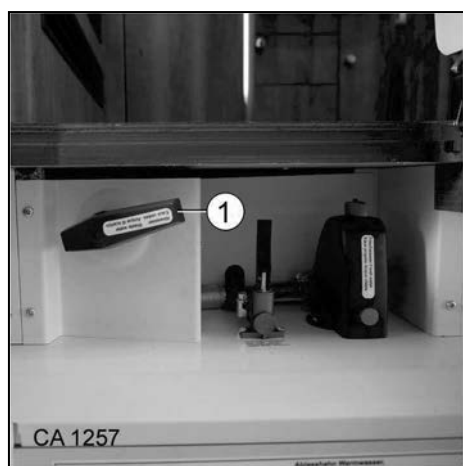
Fig. 142 Vidange du réservoir des eaux usées
