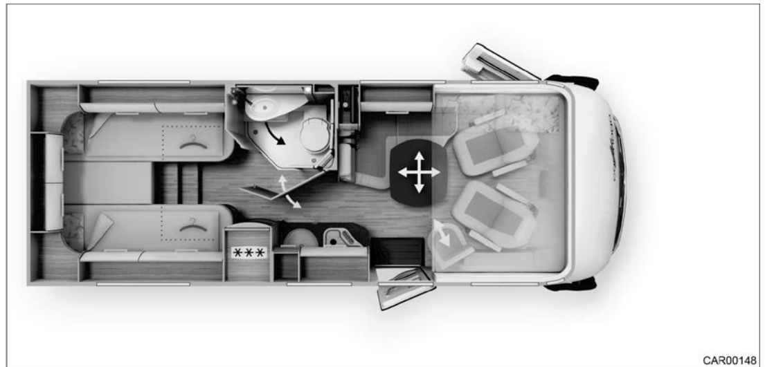
Fig. 92 Création d'un dressing au niveau de la salle de bain combinée côté conducteur
