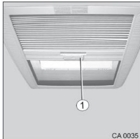
Fig. 52 Stores sur le lanterneau
