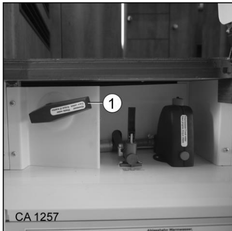
Fig. 143 Vidange du réservoir des eaux usées
