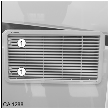
Fig. 132 Grille de ventilation du frigo
