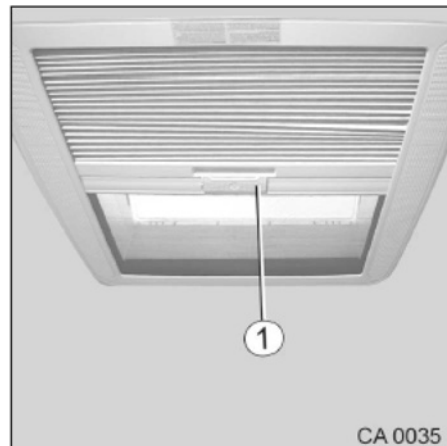
Fig. 60 Stores du lanterneau
