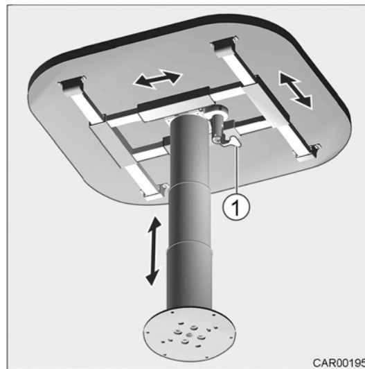
Fig. 68 Table abaissable (sans levier) et coulissante (avec levier)
