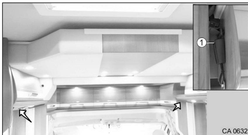
Fig. 75 Lit de pavillon central électrique, fermé
