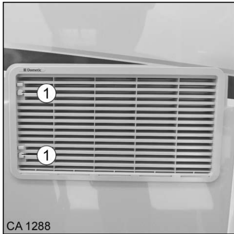
Fig. 124 Grille de ventilation du frigo
