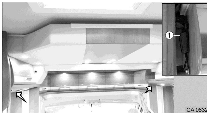
Fig. 71 Lit de pavillon central électrique, fermé
