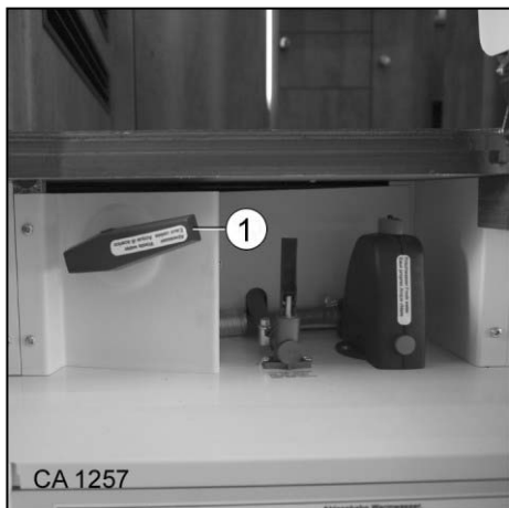
Fig. 142 Vidange du réservoir des eaux usées
