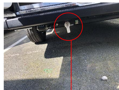
Vanne de vidange réservoir eaux usées
